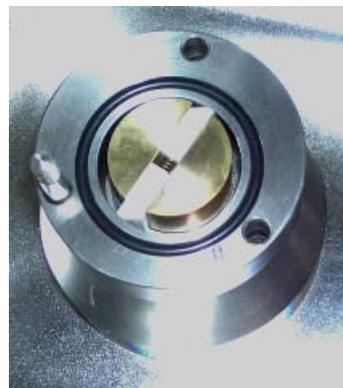
Abb. 3.5: Pumpengehäuse
