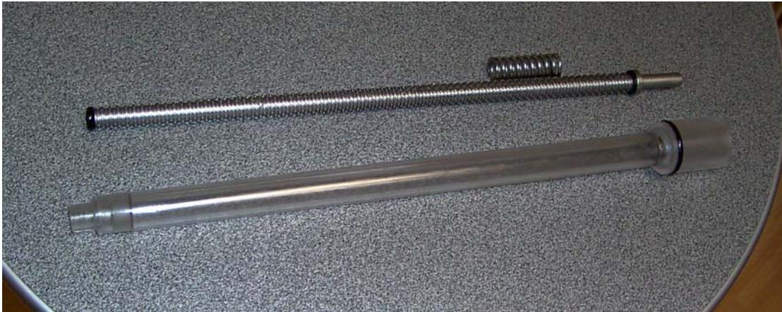
Abb. 3.6: Aufschlagsystem aus Kunststoff und Metall
